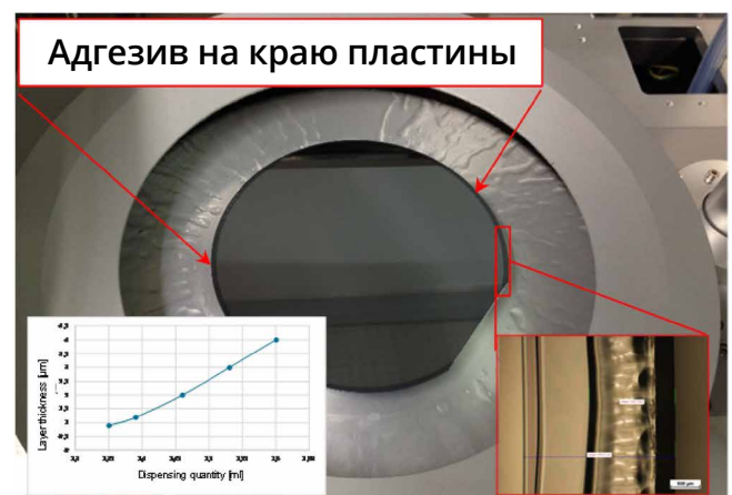
Рис. 6. Пластина-носитель после нанесения адгезива на край, а также зависимость толщины слоя от наносимого количества материала при постоянной скорости вращения 300 об/мин
